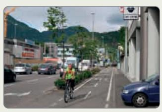
Ottima soluzione ricavata mediante la realizzazione di una corsia ciclabile bidirezionale riservata sul marciapiede. La corsia dedicata al pedone costituisce indispensabile franco di attestamento per lo sbocco del passo carrabile
