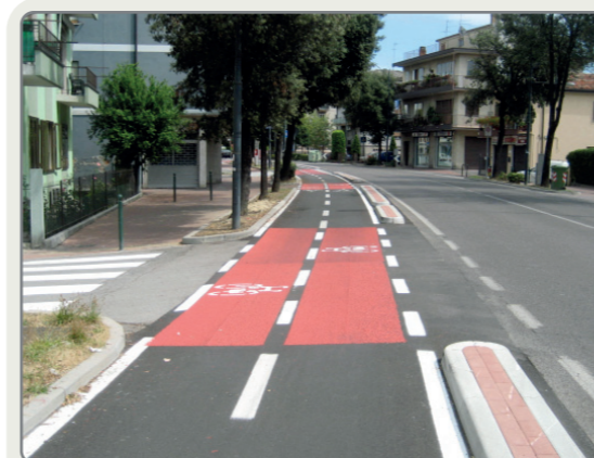
ATTRAVERSAMENTO CICLABILE BIDIREZIONALE DAVANTI A STRADA LATERALE A DUE SENSI
