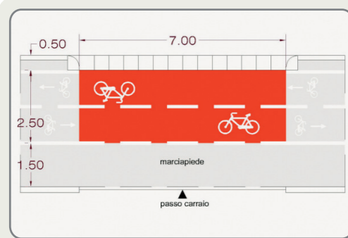
CONTINUITÀ DEL MARCIAPIEDE E DELLA PISTA CICLOPEDONALE PRESSO LO SBocco DI UN PASSO CARRAIO In questo caso non si tratta di una "intersezione" e neppure di un attraversamento, quindi non va realizzata di norma la specifica segnaletica orizzontale. Si suggerisce comunque la colorazione rossa del tappeto per evidenziare la particolare attenzione che richiede l'interferenza di due utenze conflittuali.
