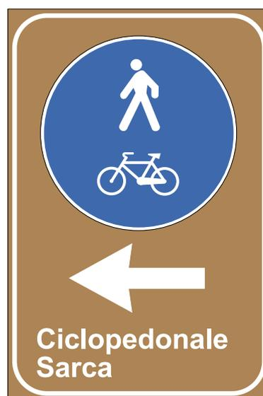
Fig 5: Cartello "turistico" per avviare a itinerario ciclopedonale e su viabilità riservata ottenuto da modifiche delle figure 360 - 363 art 136 DPR 495/92
