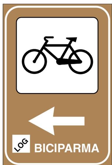
Fig 4: Cartello "turistico" per avviare a itinerario ciclopedonale generico ottenuto da modifiche delle figure 360 - 363 art 136 DPR 495/92
